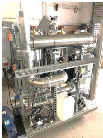
Abb. 1: Beispielhafte Abbildung eines Wärmespeichers im Labormaßstab
