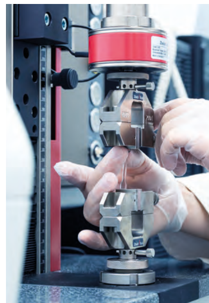
Arbeiten an einer Prüfmaschine zur Ermittlung von Werkstoffkennwerten an der EAH Jena; Foto: Sebastian Reuter
