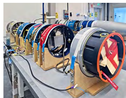
Die Rakete in Einzelmodule zerlegt. Ganz oben: GAMEon mit Gleiter; Foto: Timon Scheler
