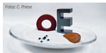
Abb. 1: verschiedene Bauformen von Ferriten: Ringkern (links), E-Kern (rechts), Multilayer-Induktivitäten (vorn)
