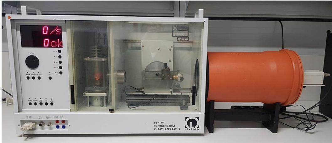
Schulröntgenerät zur Vermessung von Röntgenspektren
