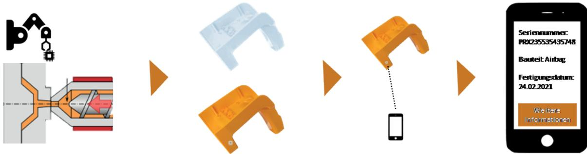
Prozesskette: Spritzgussverfahren mit Integration des RFID-Chips bis zum digitalen Zwilling
