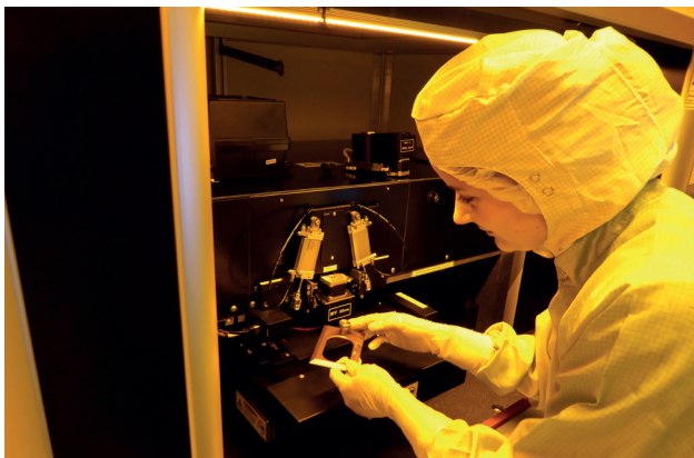
Abb. 2: Installiertes System zur direkt-schreibenden Laserlithografie (Heidelberg Instruments DWL66+)
