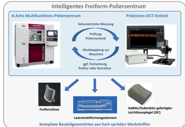
*Feedback-Loop für Präzisionspolitur durch 6-Achs-Multifunktionszentrum mit at-line SSD-Messtechnik*
