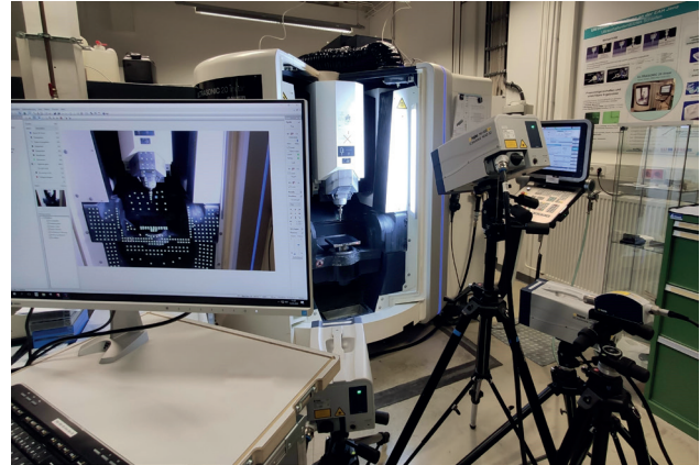
Aufbau zur hochauflösenden, laserbasierten Schwingungsmessung an einer CNC-Schleifmaschine
