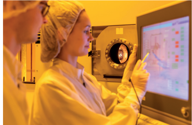
Die hyperchromatischen Elemente werden mit der Anlage zum reaktiven Ionenstrahlätzen (RIBE) hergestellt. (Foto: Reuter/EAH Jena)
