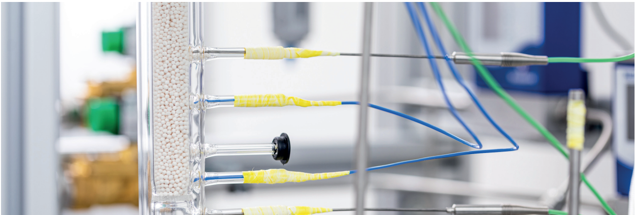
Laborwärmespeicher der EAH Jena mit Zeolithschüttung und Thermoelementen (Foto: EAH/Reuter)
