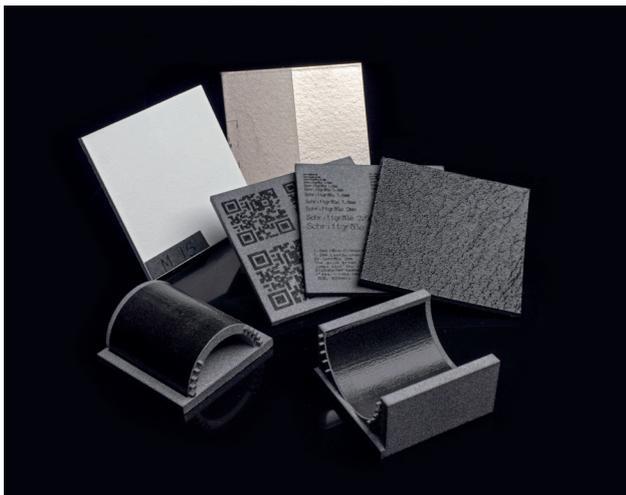
Beispiel des Funktionalisierens additiv gefertigter Bauteile: 3D-Laserpoliert (vorn), laserbeschriftet/-texturiert (mittig), pulverbeschichtet und metallisiert (hinten).
