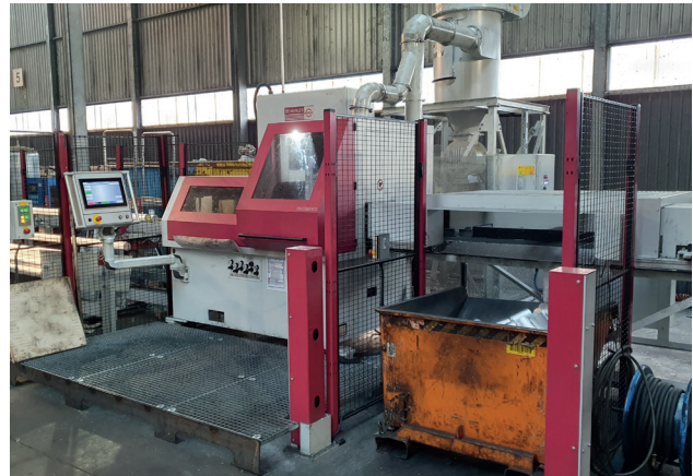
Sägemaschine für den Zuschnitt von Aluminium Rundstangen (Foto: Heine-Beisswenger Stiftung & Co. KG)
