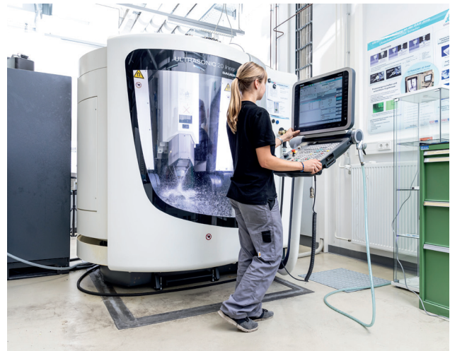
5-Achs –Ultrasonic-Schleifmaschine mit Programmier- und Sensoreinheit (Foto: EAH/Reuter)
