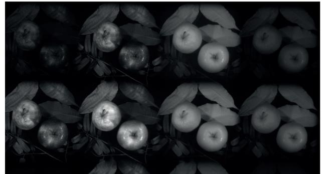
Rohbild einer kompakten Multispektralkamera mit lateral strukturiertem Filter-Array ©Fraunhofer IOF
