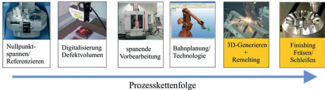
*Prozesskettenfolge eines automatisierten Laserauftragschweißprozesses zum Generieren von Werkzeugen und Formen*
