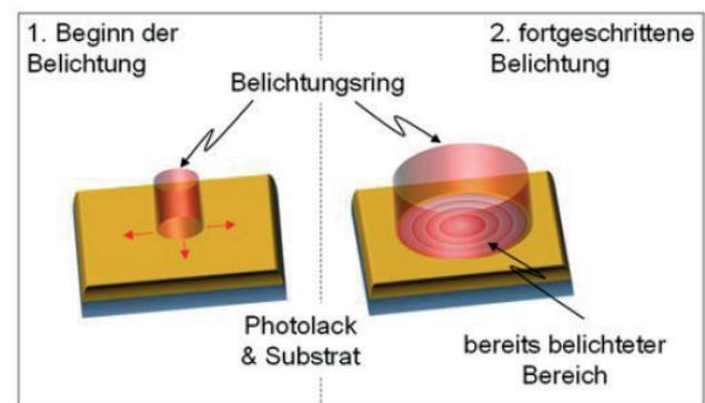
Schematische Darstellung des Belichtungsablaufs: Begonnen wird mit einem kleinen Ringdurchmesser im Zentrum des Substrats (links). Über die gleichzeitige Vergrößerung des Ringdurchmessers und Steuerung der Belichtungsdosis werden kontinuierlich radiale Profilformen erzeugt (rechts). Positionen adressieren und so beliebige 3D-Strukturen erzeugen.
