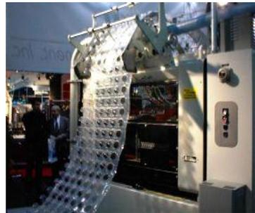
Thermoformverfahren an einem Automaten hergestellt, der aber auch für Plastikgeschirr genutzt werden kann, ein Produkt, das von einem Kunden in Sachsen abgerufen
