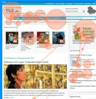
Die Bindung der Aufmerksamkeit auf einen Stimulus (bspw. Anzeige oder Webseite) sowie der Blickverlauf lassen sich mit einem Scan Path darstellen. Mit einem Kreis werden die Fixationen bestimmter Bereiche abgebildet. Der Durchmesser des Kreises beschreibt die Fixationslänge.
