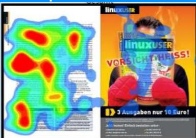
Durch eine Heat Map werden die Blickbereiche und Fixierungsintensitäten eines Stimulus farblich abgebildet. Hierbei steht blau für eine geringe Fixationszeit, grün für eine mittlere und rot für eine lange Fixationsdauer. Die Auswertung kann über einen Einzelnen oder kumuliert über alle Probanden erfolgen.
