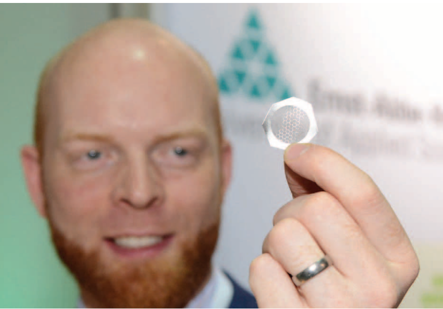
Mittels UKP-Laser erzeugtes Wabengitter in Metallfolie Foto: Karsten Seifert (Die Redaktion dankt sehr herzlich für die freundliche Genehmigung.)
