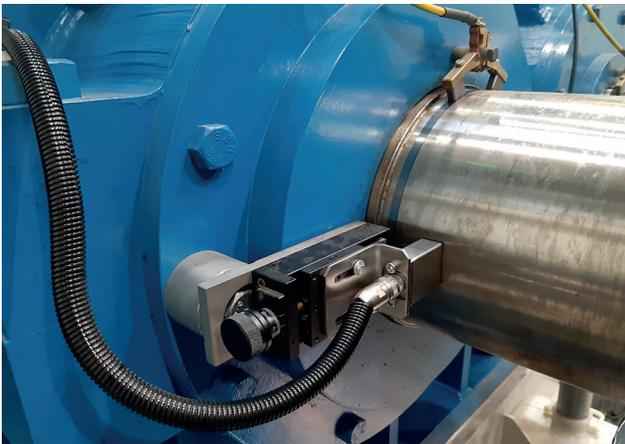
Kontaktloser Magnetfeldsensor (VEM Sachsenwerk, HZDR)
