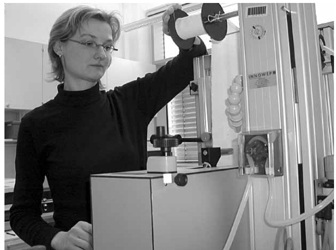
Doktorandin Kerstin Lau bei Arbeiten am Prüfgerät ABREX ® zum Test der Abriebfestigkeit optischer Beschichtungen. Foto: Weber, Fraunhofer IOF
