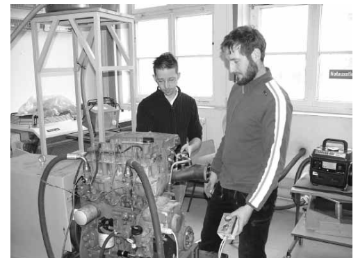
Andreas Träger und Steffen Hoffmann untersuchen das akustische Verhalten einer Ölwanne eines Dieselmotors
