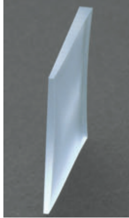
Demonstrator einer Alvarez-Freifform vor dem Polieren
