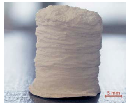
Bild 2: Additiv gefertigter Grünkörper aus Wasserglas für die weitere Druckverglasung, Foto: AG Bliedtner
