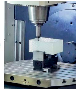
Großvolumige additive Bauteilfertigung (links) und subtraktive Nachbearbeitung (rechts), Fotos: Michel Layher
