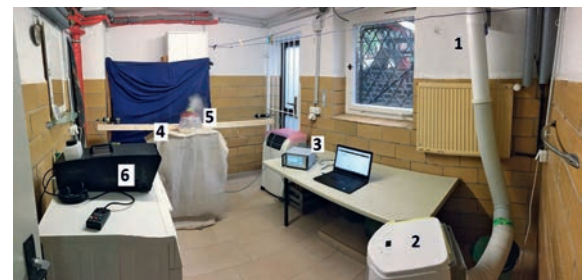
Abbildung 4: Ansicht des kleinen Modellraumes für erste praktische Auswaschversuche.
