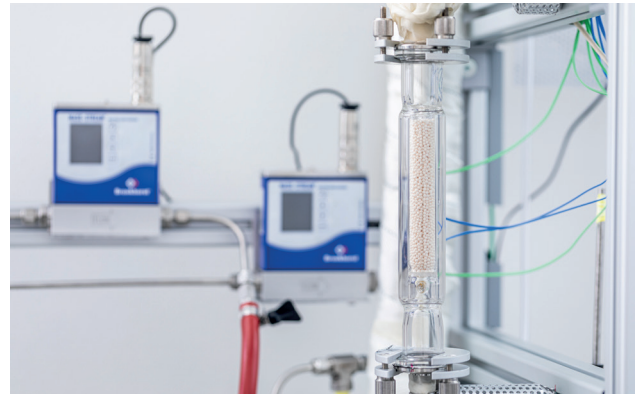
Laborwärmespeicheranlage der EAH Jena mit Zeolithschüttung (Foto: EAH/Reuter)
